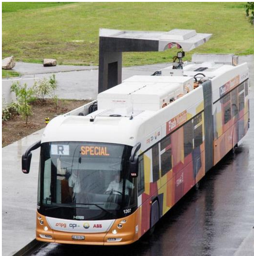
圖 3 ABB 和 HESS 合作開發的超級電容巴士
